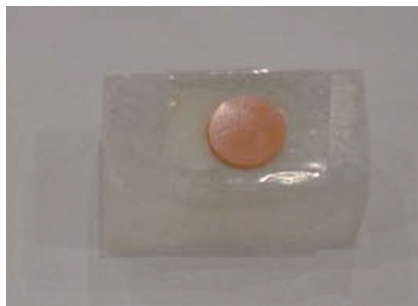
図1 セメント層を形成した試験体
